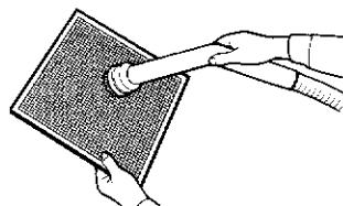
**ご注意** ●前フィルター・下フィルターにほりかたまると、温風量が少なくなり暖房出力が低下し、ストーブ内の温度が上昇して過熱防止装置が作動する原因になります。
