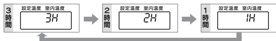
延長時間セレクトキーを押している間、デジタル表示部には延長時間が表示されますが、手を放すと自動的に温度表示に切りかれます。
