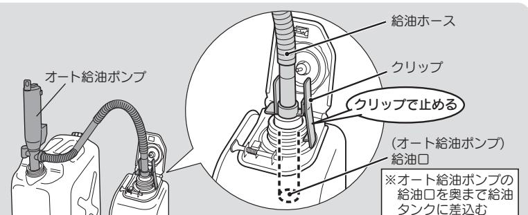
※オート給油ポンプの給油口を奥まで給油タンクに差込む
