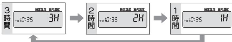
〔延長時間セレクトキーを押している間、デジタル表示部には延長時間が表示されますが、手を放すと自動的に温度表示に切りかわります。〕
