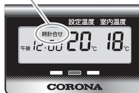
●時刻設定キーを押して、デジタル表示部を時計合せ表示にしてください。
