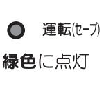
※パワーセーブ運転（☞ 9ページ）時は、どの風量設定でも運転（セーブ）ランプはオレンジ色に点灯します。
