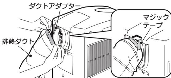
排熱ダクトをダクトアダプターに取り付け、マジックテープでしっかり固定します。
