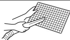
エアフィルターのネットは、はずして掃除機を使用するか軽くたたいてください。汚れのひどいときは、中性洗剤を溶かしたぬるま湯か水で洗うと効果があります。洗った後は、よくすすぎ、日陰で乾かしてからもとどおり取り付けてください。
