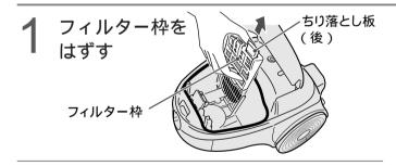
フィルター枠から 排気清浄フィルタ ーをはずす
