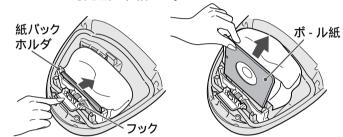
新しい紙パックのボール紙を、紙パッ クホルダの挿入溝に確実に差し込む
