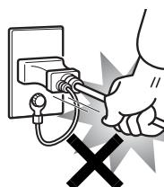
ACアダプタや電源ケーブルの電源プラグを抜くときは、電源コードを引っ張らず、必ず電源プラグ
