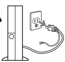
メモリの取り付けや取り外しを行うときなど、本体カバーを開ける場合は、パソコン本体および接続されている機器の電源を切り、電源プラグをコンセントから抜いた後、しばらく経ってから本体カバーを開けてください。
