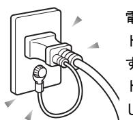
電源プラグをコンセントに差し込む前に、必ずアース線をコンセントのアースネジへ接続してください。
