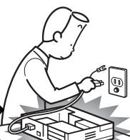
本体カバーを外した状態で電源プラグをコンセントに差し込んだり、電源を入れたりしないでください。感電・火災の原因となります。
