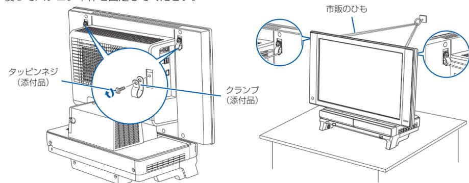
クランプは、パソコン本体背面の転倒防止用ネジ穴（2ヶ所）に、タッピンネジで止めてください。クランプの取り付けが終わったら、丈夫なひもで、しっかりした壁や柱にパソコンを固定してください。壁や柱への固定に金具をご使用になる場合は、ひもが外れない形状のものをお使いください。
