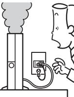
本製品は主電源コンセントの近くに設置し、遮断装置(電源プラグ)へ容易に手が届くようにしてください。
