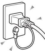
電源プラグをコンセントに差し込む前に、必ずアース線をコンセントのアースネジへ接続してください。
