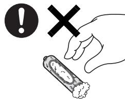
長時間使用しないときは、乾電池の液漏れを防ぐため、乾電池を取り出しておいてください。
