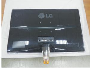
2. スタンド台の背面にコインでねじを時計方向に締め付けます。
