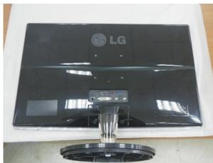
2. ディスプレイをスタンド台から取り外す場合、コインでねじを反時計方向に回します。
