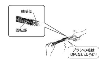
回転部、お手入れカバーを水で洗い、 陰干しして十分に乾燥させる
