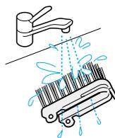
3 接続管の凸部とブラシ毛部の凹部をあわせて、カチツと音がするまではめ込む
