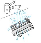
接続管の凸部とブラシ毛部の凹部をあ わせて、カチッと音がするまではめ込む
