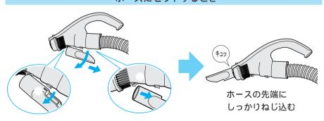
すき間ノズルの中央部分を突起部からはずす スライドさせてはずす
