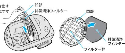
フィルターお手入れ口ボ、プリーツフィルター、フィルター枠、排気清浄フィルター をそれぞれ水洗いする
