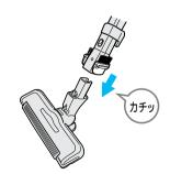
運転中は、床ブラシの着脱をしないでください。 無理に延長管を前に倒さないでください。故障の原因になります。 接続管(ブラシ毛部はのぞく)は水洗いしないでください。(170-3) 床に強く押しつけないでください。傷をつけることがあります。
