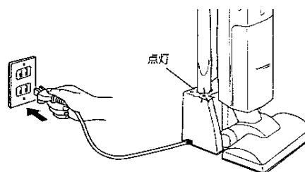
充電台の電源プラグを交流100Vのコンセントに差し込むと、本体の充電表示ランプ（赤）が点灯し充電が終了すると緑ランプが点灯します。
