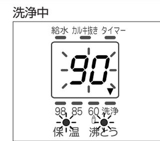
▶ 保温ランプと沸とうランプが点滅し、洗浄終了までの残り時間を分単位で点滅表示
