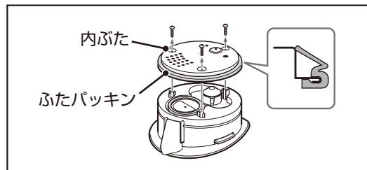
**3** 逆流止め・逆流止めガイドがはずれたときは、右図の位置にセットする
