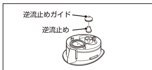
**4** 内ぶた裏側の凹部と逆流止め取り付け部を合わせ、内ぶたのネジ穴を外ぶたのネジ取り付け部に合わせ、ネジで取り付ける
