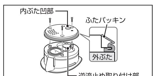
4 内ぶた裏側の凹部と逆流止め取り付け部を合わせ、内ぶたのネジ穴を外ぶたのネジ取り付け部に合わせ、ネジで取り付ける
