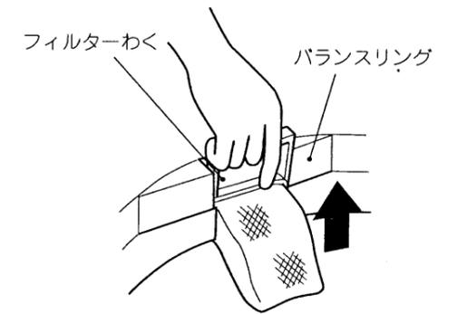
**2** フィルターのネットを裏返して、糸くずを水中で洗い落とす。
