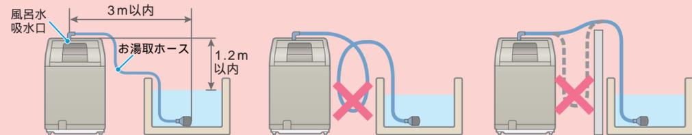
お湯取ホースは、風呂水吸水口からAg除菌お湯取ユニット先端までの距離が3m以内になるように設置してください。浴槽水面から風呂水吸水口までの高さは1.2m以内に設置してください。
