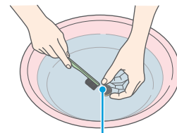
給水口のフィルター
