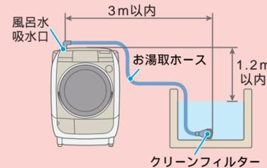
お湯取ホースは、風呂水吸水口からクリーンフィルター先端までの距離が、3m以内になるように設置してください。風呂水吸水口から浴槽水面までの高さは1.2m以内に設置してください。
