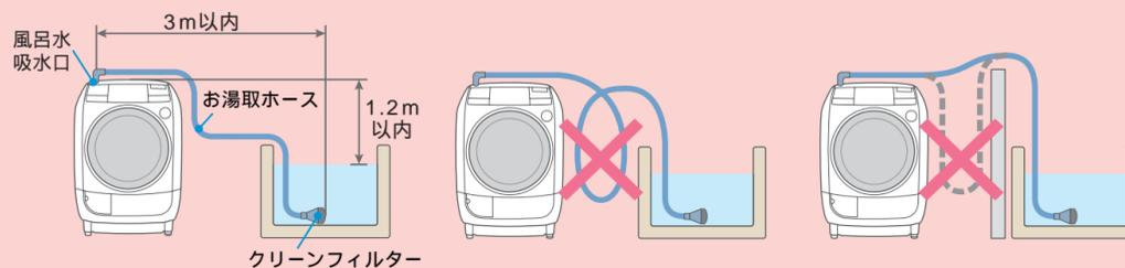
お湯取ホースは、風呂水吸水口からクリーンフィルター先端までの距離が、3m以内になるように設置してください。
