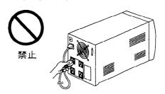
本機を使用中に電源プラグを出力コンセントに差込むと異常電流が流れて火花が発生し、やけどなどのけがをする恐れがあります。
