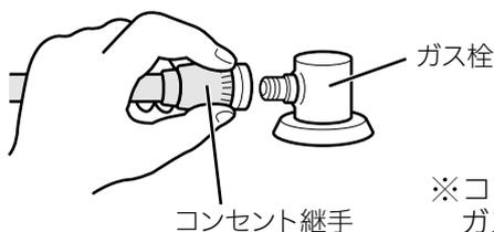
※コンセント継手を差し込むと、ガス栓が開きます。
