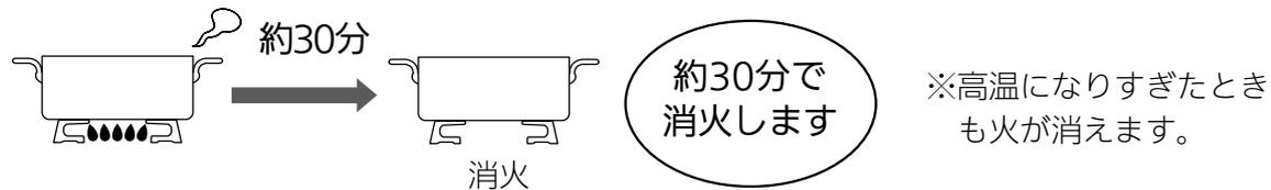
※センサー解除していないときでも、連続して約2時間使用すると自動で火が消えますので、煮込み料理のときにはご注意ください。
