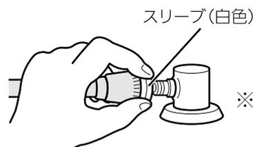
※コンセント継手はずれると、ガス栓が閉まります。
