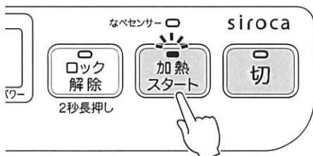
のパイロットランプが点灯し、火力「強」で加熱がスタートします。
