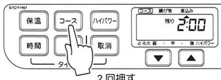
「煮込み」コースに設定され、初期状態の残り時間（煮込み時間）「2時間」で煮込み調理がスタートします。
