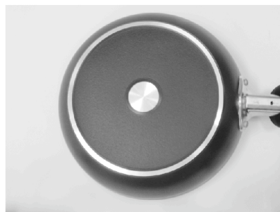
底面を鉄溶射加工したもの
