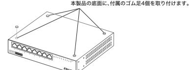
▲ ・AC電源に近い平らな場所に本製品を置き、本製品の周囲に通気のためのスペースを5cm以上確保します。
