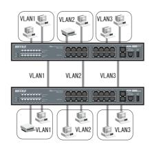
· タグVLANを使用する場合 スイッチ間を接続するときは、VLANグループの数に関わらず、1本のUTPケーブルで 接続できます。VLANグループを新たに追加しても、ケーブルを追加する必要はありま せんので、ケーブル配線が容易になります。
