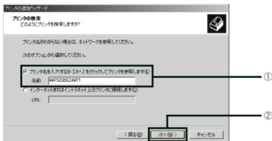
①「プリンタ名を入力するか[次へ]をクリックしてプリンタを参照します」を選択し、名前欄に「¥¥サーバ名¥ポート名」の形式でプリンタ名を入力するか、[次へ] をクリックして表示されるウィンドウでプリンタを指定します。
