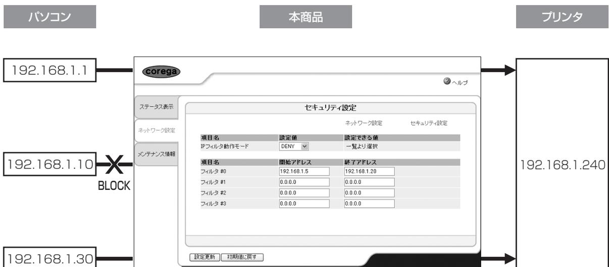
図のように、「ALLOW」（許可）モードと「DENY」（拒否）モードでは、3台のパソコン（192.168.1.1、192.168.1.10、192.168.1.30）からプリンタにアクセスした結果が異なります。
