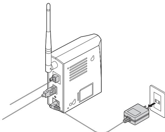
**5** 本商品から LAN ケーブルを抜き、AC アダプタを電源コンセントに差し込みます。
