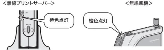
メモ 無線親機に正しく接続されなかった場合、無線親機のAOSS(またはSECURITY)ランプが2回点滅から点滅に変わります。その場合は、再度手順 9 から実行してください。
