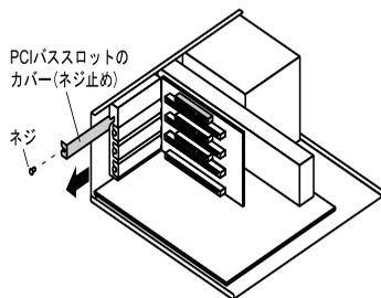
PCI バスアダプタを取り付ける箇所の PCI バススロットのカバー（ネジ止め）を取り外します。
