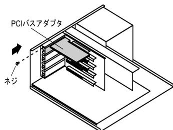
手順 3 で外したネジで、PCI バスアダプタを固定します。
