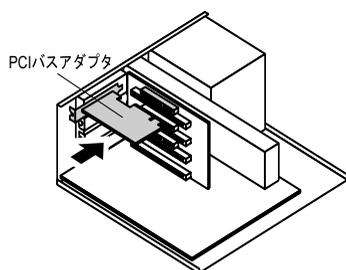
PCI バスアダプタを PCI バススロットに差し込みます。
