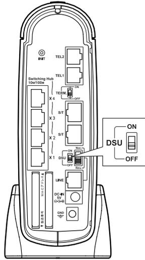
2. 別売りの S/T ケーブルを AirStation の S/T ポートに接続します。
