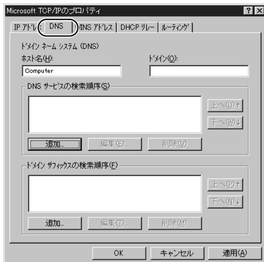
**8**  をクリックし、「DNSサーバ：」入力欄に入力し、 をクリックする
