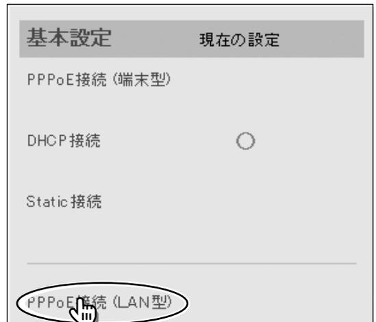
2 「ユーザ名」、「パスワード」、「DNS サーバ 1、2」、「IP アドレス」、「ネットマスク」を入力し、プロバイダから指定がある場合は「サービス名」、「アクセスコンセントレータ名」、「ドメイン名」を入力する
