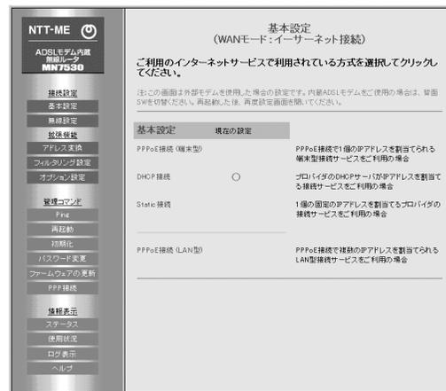
インターネット側の接続に対応した画面が表示されない場合は、ADSL/WAN切替スイッチが適切にセットされていない可能性があります。必ずMN7530の電源を切ってADSL/WAN切替スイッチを切替えてください。（⇒ 24～26ページ）
