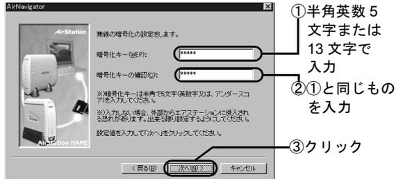
お使いの無線 LAN カード / アダプタによって、暗号キーに入力する文字数に制限があります。なお、AirNavigator では設定に使用する LAN ボード / カードに関係なく、設定する対象の AirStation によって入力できる暗号キーの文字数が決まります。したがって、5 文字の暗号キーしか設定できない無線 LAN カード / アダプタを使用して設定しても 13 文字の暗号キーを入力することができます。ただし、13 文字の暗号キーを設定してしまうと、設定に使用したその無線 LAN カード / アダプタでは AirStation に接続できなくなります。
