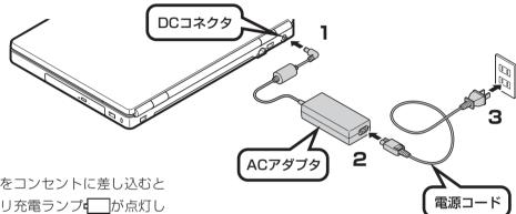
プラグをコンセントに差し込むと バッテリ充電ランプ が点灯して、バッテリの充電が始まります。 バッテリがフル充電されるとバッテリ充電ランプが消灯します。
