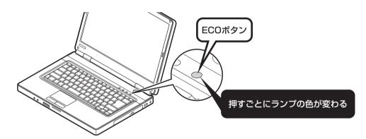
たとえば、外出先でバッテリのみで使用するときは、「LaVie省電力」に設定しておくとバッテリが長持ちします。比較的電力を必要とする処理をするときは、「LaVie高性能」に設定すると、処理が速くおこなわれます。
