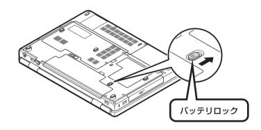
バッテリイジェクトレバー(**国**)を図の矢印の方向にスライドさせたまま(①)、バッテリパックを持ち上げて取り外す(②)
