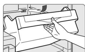
2 チルドケースを手前に少し引き出した後、チルドルーム天井板を斜め上から押し込み、左側のツメを差し込む(図1)。そして、チルドルーム天井板の奥を持ち上げながら押し込み、フックを冷蔵庫背面の穴に差し込む(図2)。
