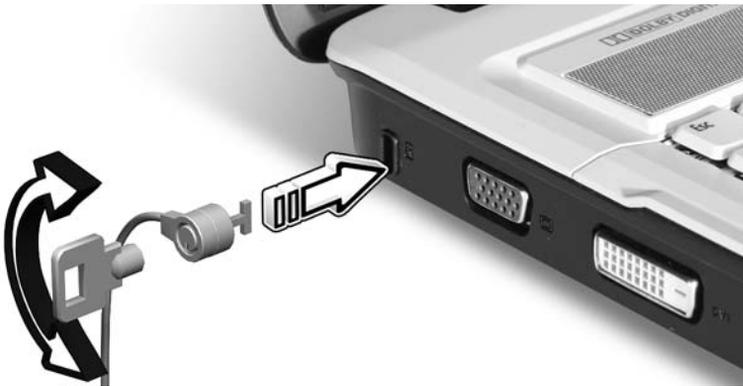
コンピュータ用安全ロックのケーブルを机やロックした引き出しの取っ手などの動かないものにつなぎます。ロックをセキュリティキーロックノッチに挿入し、キーをまわしてロックを固定してください。
