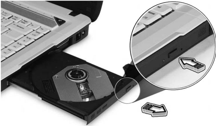
コンピュータがオフの状態の場合は、緊急用イジェクトホールにペーパークリップを差し込むと光学ドライブトレイが出てきます。
