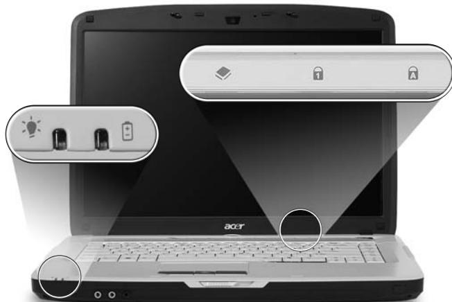
フロントパネルのインジケータは、コンピュータカバーが閉じた状態でも見えるようになっています。
