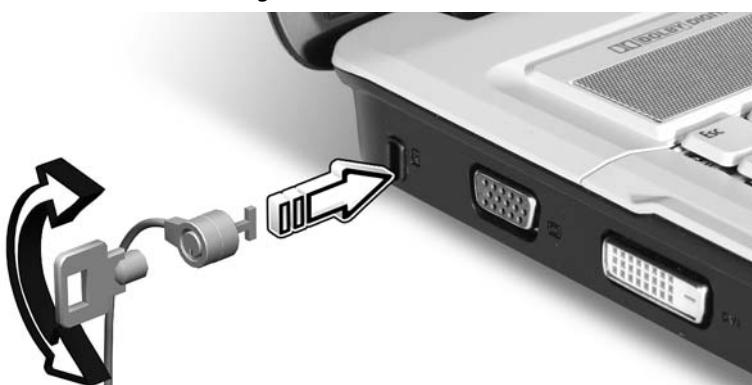
コンピューター用安全ロックのケーブルを机やロックした引き出しの取っ手などの動かないものにつなぎます。ロックをセキュリティキーロックノッチに挿入し、キーをまわしてロックを固定してください。
