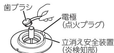
※電極(点火プラグ)の先端はとがっていますので、けがなどに注意してください。
