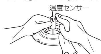
※強い力を加えると温度センサーが傾いて、なべ底に密着しないことがあります。また、温度センサーを無理に回転させないでください。故障の原因になります。
