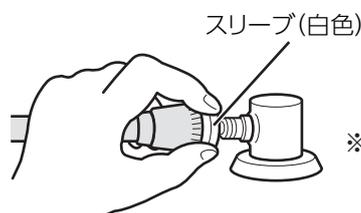
※コンセント継手がはずれると、ガス栓が閉まります。
