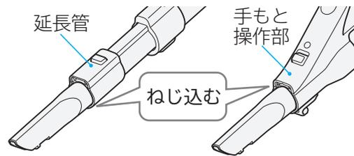
付属のすき間用吸口ホルダーを延長管に取り付けて、収納することができます。
