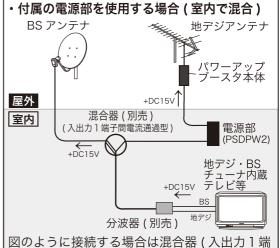
子間電流通過型)及び分波器をお買い求めの上、 BSと地デジを室内で混合してください。
