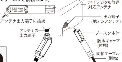
※ 屋外設置の場合は必ず下 (斜め 45°) に向くように取付け てください。
