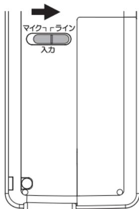
**3** 市販のオーディオケーブルを使って、本機の外部入力端子に外部機器の音声出力(ヘッドホン)端子を接続します。
