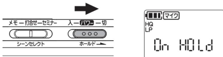
パワー（電源）／ホールドスイッチを下図の←方向（入側）にすると、次の画面が表示されて操作できるようになります。
