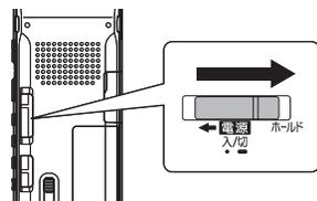
電源スイッチを戻すと、「ホールド解除」が表示され、ホールド機能が解除されます。
