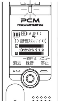
レベルメーターが右いっぱいには振れ、\*録音LEDが点灯(録音LED設定が「ON」時)した場合、音が歪んで録音されます。[◀◀]を押してマイク感度を下げてください。
