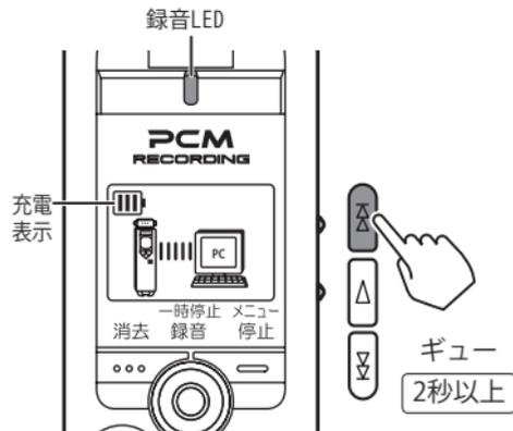
本機の液晶パネルがPC接続中の表示であることを確認して、[▶▶]を長押しする
