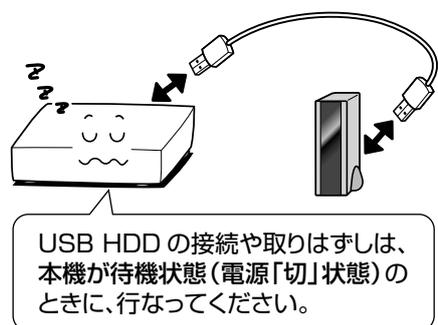
本機と USB HDD を接続したり、取りはずすときは、本機と USB HDD の電源を必ず「切」にしてください。
