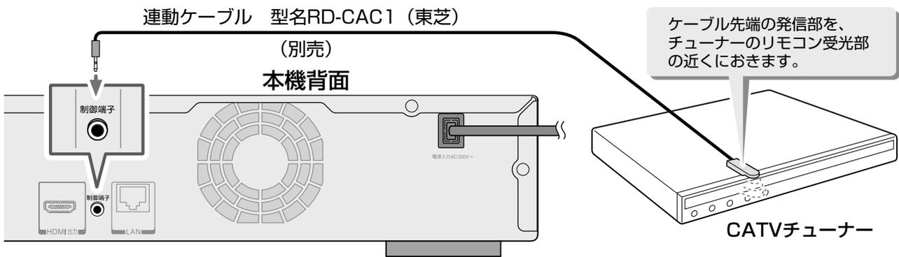
\*Ir システム：リモコンなどで使われている赤外線信号を利用して、スカパー!チューナー / CATV チューナーの電源の入 / 切や、予約録画時にチューナーのチャンネルを本機から操作できるようにするシステムです。
