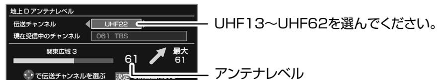
**10** アンテナレベルが最大になる方向でアンテナを固定し、**決定**を押す
