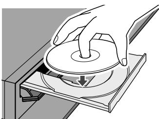
タイトルなどが印刷されたラベル面を上にして、内側の溝に合わせて置きます。
