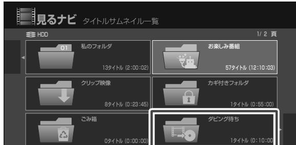
ダビングに失敗したり、途中でキャンセルしたりした場合は、「ダビング待ち」フォルダが表示されることがあります。フォルダが表示されたときは、⇒72 ページの手順に従って、ダビング先に BD または BDAV フォーマットの DVD を選び、残っているタイトルをダビングしてください。フォルダにあるタイトルをダビングしたり、削除したりすると、フォルダは表示されなくなります。
