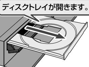
電源が「切」状態で ▲トレイ開/閉 を押すと、自動的に電源が「入」になり、トレイが開きます。
