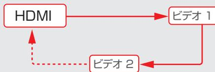
テレビのリモコンの『入力切換』ボタンを繰り返し押して、画面に「HDMI」を表示させます。
