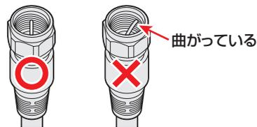
● 同軸ケーブルにF型コネクターを取付加工する場合は、芯線とアース線(網線)がショートしないようにしてください。
